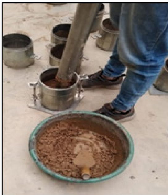
Figura 5. Ensayo de compactación
