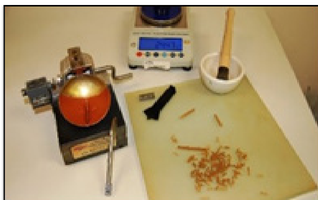
Figura 2. Ensayo de Limites
